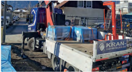
Ladepritsche: Alu mit Bordwand, B: 2,45 m, L 4 m, LH 1,5 m
