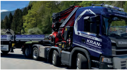
Scania S4M 4-achser F1150 EG 27,5 to, GG: 32 to, L 8,5 m
