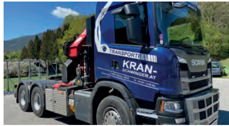
Scania S4M 3-achser HMF4020 EG 17 to, GG: 26 to, L 7,2 m
