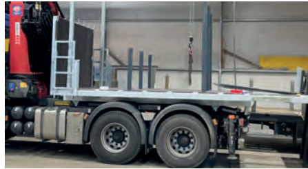
Ladepritsche: Stahlplateau, B: 2,45 m, L 4,5 – 6 m ausziehbar, LH: 1,5 m, Containerverriegelung
