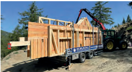
Tandemanhänger: EG 3,8 to, GG: 18 to, LG 6,4m, LH: 890mm, Containerverriegelung, für Fertigteiltransport
