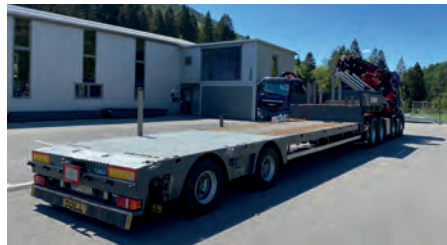
Doll Lenksattel: Tiefbeet, EG: 9,2 to, GG: 25 to, LG: 4/9m, LH 880mm, Containerverriegelung; für Fertigteiltransport
